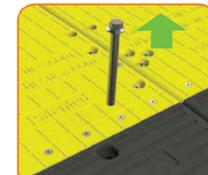
1. Remova os parafusos que foram utilizados para ancorar as placas na estrada.
