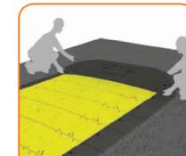
2. Começar pelas seções terminais, levantar com cuidado a placa, inclinando-a e deslizando para fora de modo a retirá-la.
