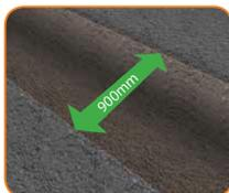
1. Garanta uma largura máx. da vala inferior a 900mm. Verifique a estabilidade da vala antes de instalar a placa.
