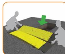
6. Coloque a placa em ângulo para que os conectores se encaixem nos slots.
