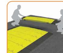
3. Repita o passo 2 para desmontar uma seção de cada vez.
