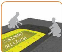
10. Se necessário, conecte as seções da placa nas extremidades. AS SEÇÕES TERMINAIS NÃO DEVEM FICAR SOBRE A VALA
